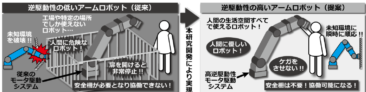
図1 従来技術と高逆駆動性多軸モータ駆動システムを用いたアームロボット
